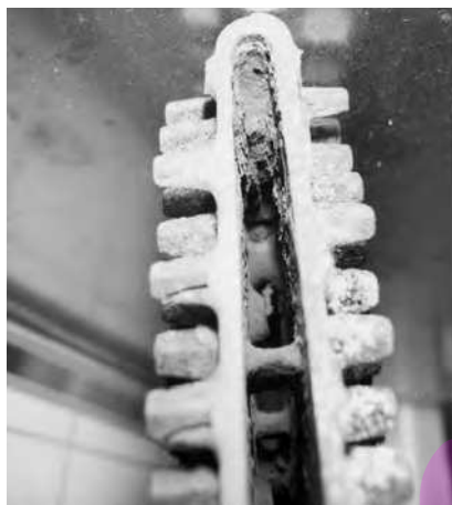
Afbeelding 8. Afzetting van corrosieproduct en kalk op lid cv-ketel
