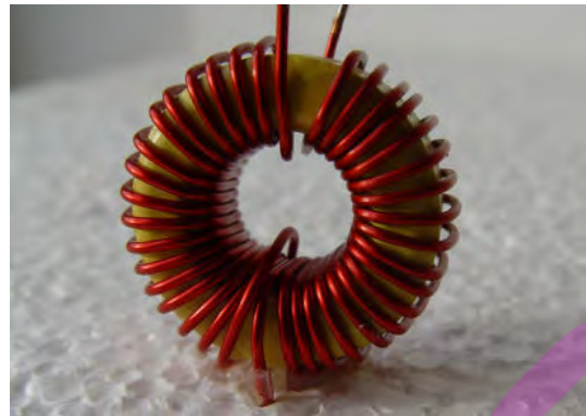
Om een ronde kern gewikkelde spoel
