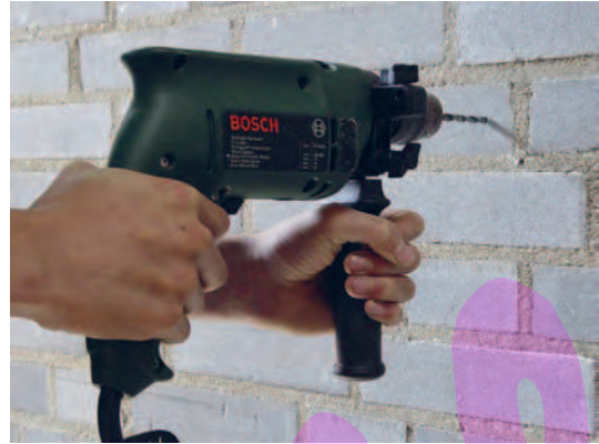
Boren met een klopboormachine en een steenboor
