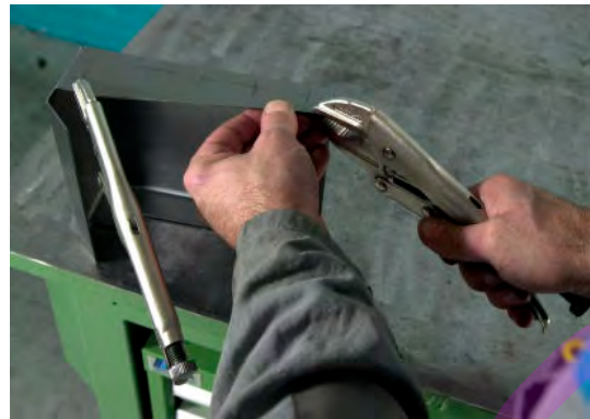
Platen klemmen met griptangen
