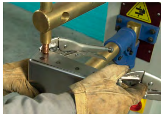
Maak de volgende puntlassen op dezelfde manier
