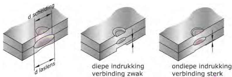
Diameter laslens en indrukking bepalen
