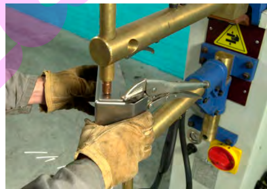
Druk de bovenste elektrode op de plaat
