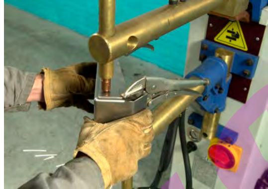
Materiaaldelen verbinden met puntlassen
