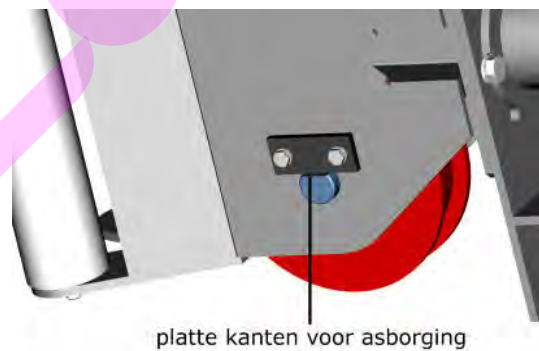
Voorzieningen aan een as voor een juist functioneren: smeergat en platte kanten voor asborging
