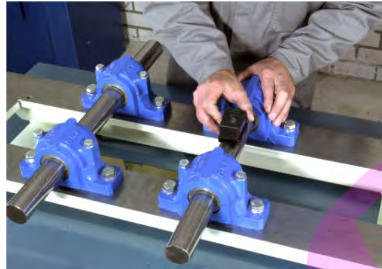
Aswaterpas op as plaatsen
