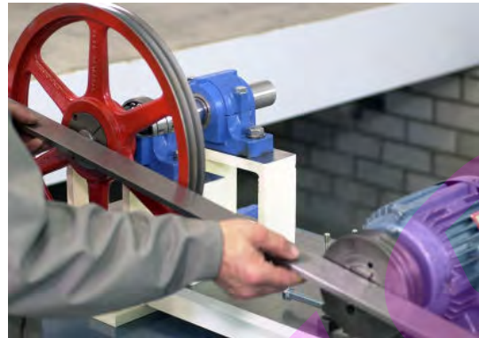
Riemschijven controleren op uitlijning
