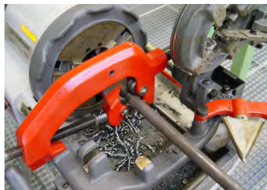
Afkorten op een combimachine
