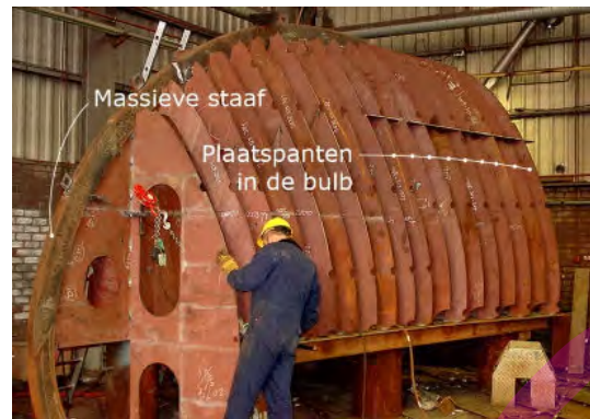
Plaatspanten in de bulb voor hoge belastingen
