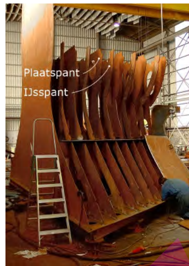
Plaatspanten en ijsspanten in voorpiek (Let op: Voorpiek ligt hier nog omgekeerd)
