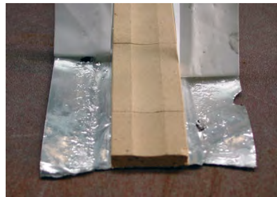
Detail keramische strip voor goede doorlassing
