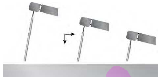
Toevoersnelheid is afsmeltsnelheid
