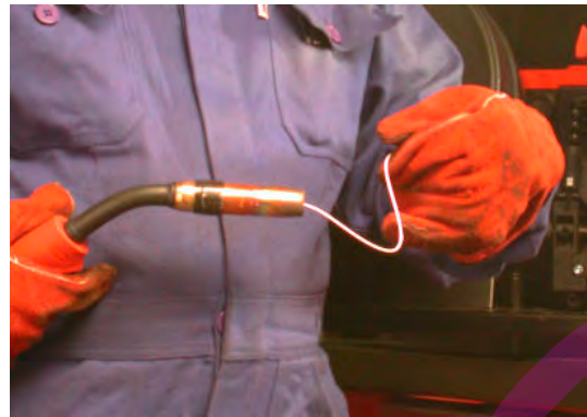
Afstelling draadaanvoerrollen controleren
