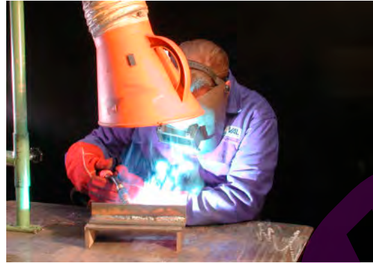
Vlamboog tussen afsmeltende lasdraad en werkstuk
