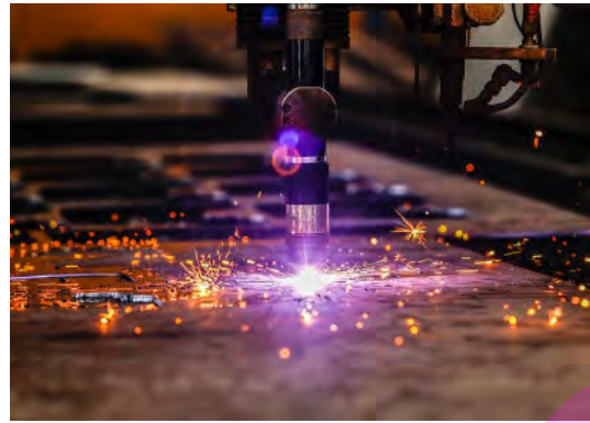
Dunne plasmaboog, grote kinetische energie
