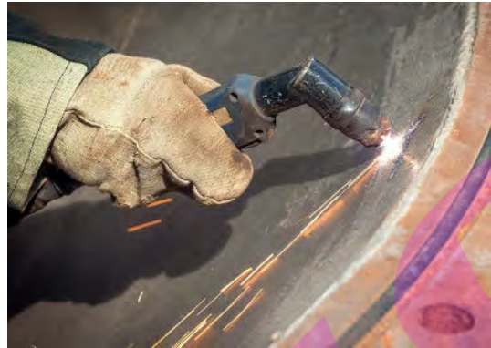
Plasmasnijden met waterinjectie als koeling
