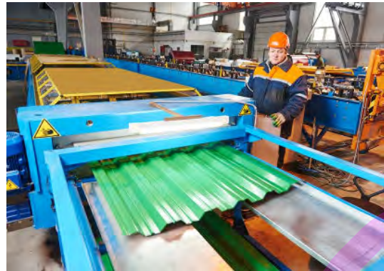
Rolvormmachine voor het maken van profielen
