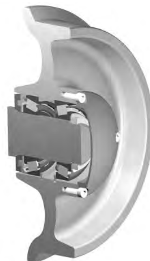
Spoorwagonwiel met slijtvast loopvlak
