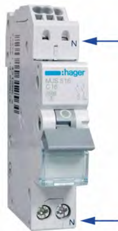
Installatie-automaat 1P+N, nulgeleider aansluiten bij N-markering
