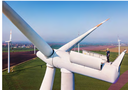
Rotor met rotorbladen, neuskegel en gondel
