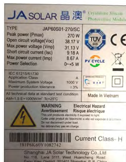
Voorbeeld typeplaatje PV-paneel
