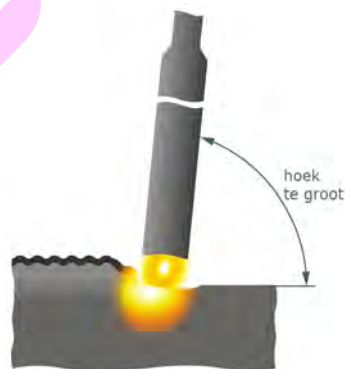
Bij een te grote hoek kan slak verkeerd vloeien
